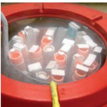
Unsere kryogenischen Haftmaterialien ermöglichen die verlässliche Identifikation von Kunststoff- und Glasbehältern, die langfristig in flüssigem Stickstoff oder unter Tiefkühlbedingungen gelagert werden. Bedruckbar mit klassischen Druckfarben, Laser Tischdruckern, wasserbasiertem Inkjet und Thermotransfer, sind sie ideal für den Gebrauch in Kliniklaboren, biomedizinischen Versuchsanstalten und anderen wissenschaftlichen Umgebungen.
